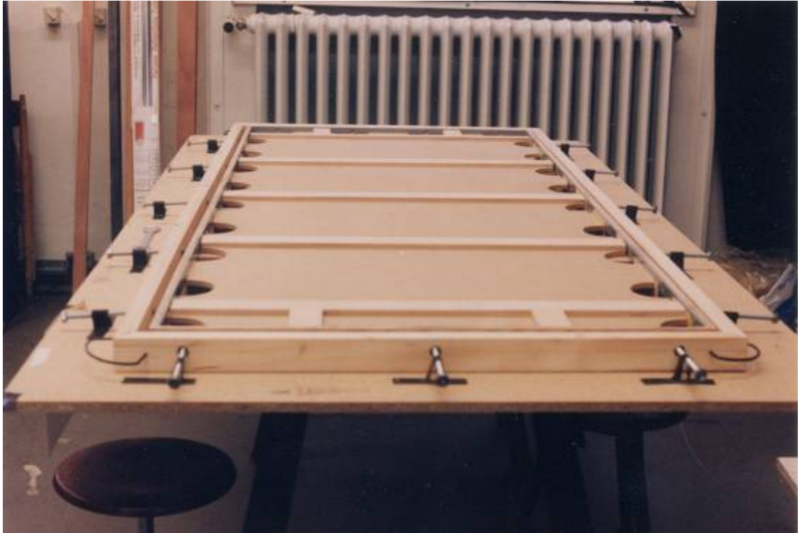
5. Aufbau der Holzrahmen vor der Bespannung.
