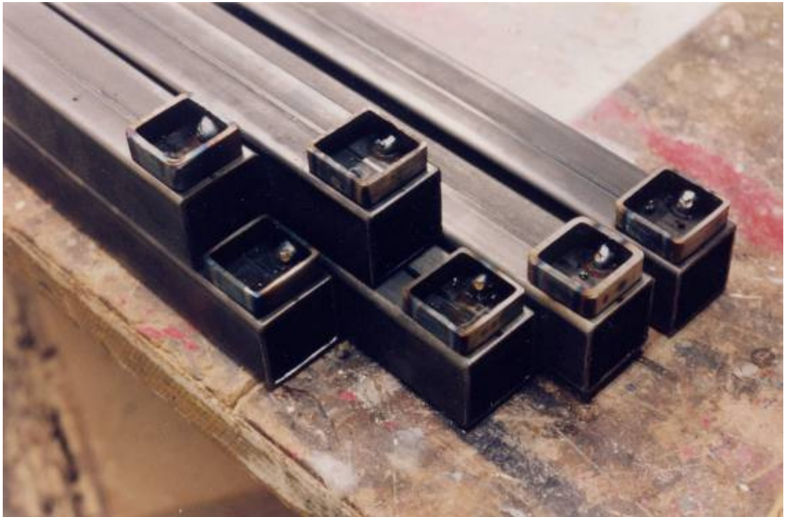
10. Quadratprofile mit Passern für das obere Querstück.
